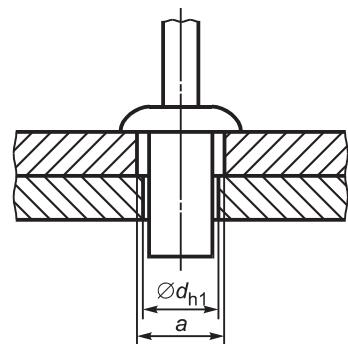
Рисунок 2 — Увеличенный диаметр отверстий для облегчения совмещения
