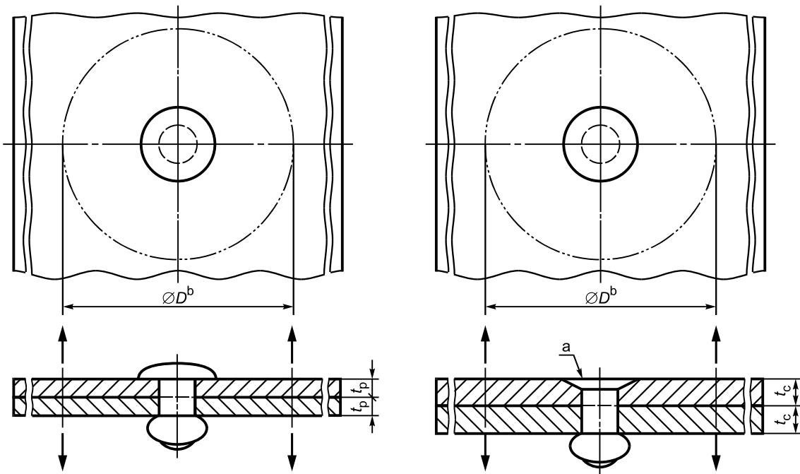
*a* — угол потая равен номинальному углу потайной головки заклепки с допуском —2°; *b* — круговая плоская поверхность вокруг оси образца с минимальным диаметром 25 мм
