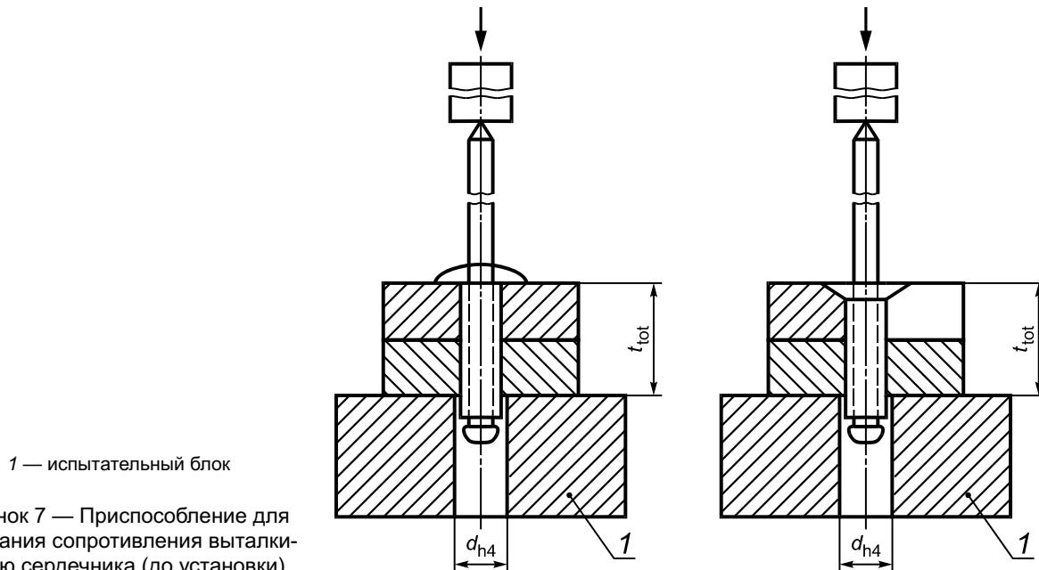
Рисунок 7 — Приспособление для испытания сопротивления выталкиванию сердечника (до установки)
