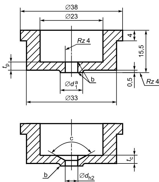
a —  $d_1 = 2d$  ( $d$  — номинальный диаметр заклепки); b — на кромках отверстий не должно быть заусенцев; c — угол потая равен номинальному углу потайной головки заклепки с допуском  $-2^\circ$
