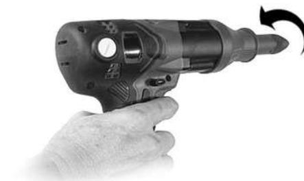
2. Установите заклепку в насадку (Хвостовик заклепки должен свободно входить в отверстие насадки) и вставьте ее в отверстие скрепляемых материалов.
