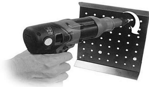
6. После установки заклепки переключите реверс в режим левого вращения и нажмите **«пуск»** для **«выброса»** из инструмента хвостовой части заклепки в контейнер. Убедитесь, что это произошло.
