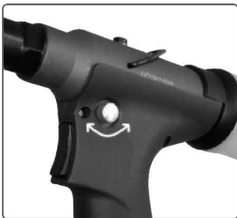
Рис.1. Для того чтобы отрегулировать подсос воздуха поверните ручку на \frac{1}{4} оборота
