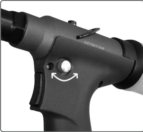
**I** Per regolare l'aspirazione ruotare la manopola di ¼ di giro
