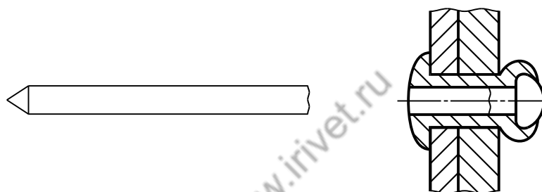
Рисунок 5 — Разрывающийся вытяжной сердечник
