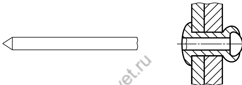
Рисунок 8 — Вытяжной сердечник с заданной точкой разрыва
