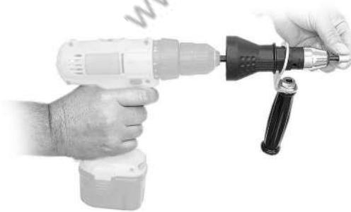
4. Установите заклепку в отверстие. Нажмите кнопку пуск (правое вращение). Вращение установочного винта за 2-3секунды с характерным треском зафиксирует заклепку в отверстии. Заклепка установлена.
