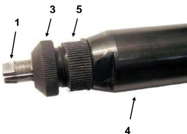
1. Выберите необходимый пробойный шип (поз. № 1) и соответствующую ему насадку (поз. № 3) (см. таблицу применения инструмента).
