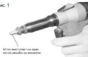
Отрегулируйте выступ штока перед установкой, заклепка должна навинчиваться полностью на шток, и он должен выступать из нее не более чем на один виток резьбы (см. Рис.1). Если шток выступает больше или меньше, требуемого положения отрегулируйте до оптимального положения (см. Рис.1).
